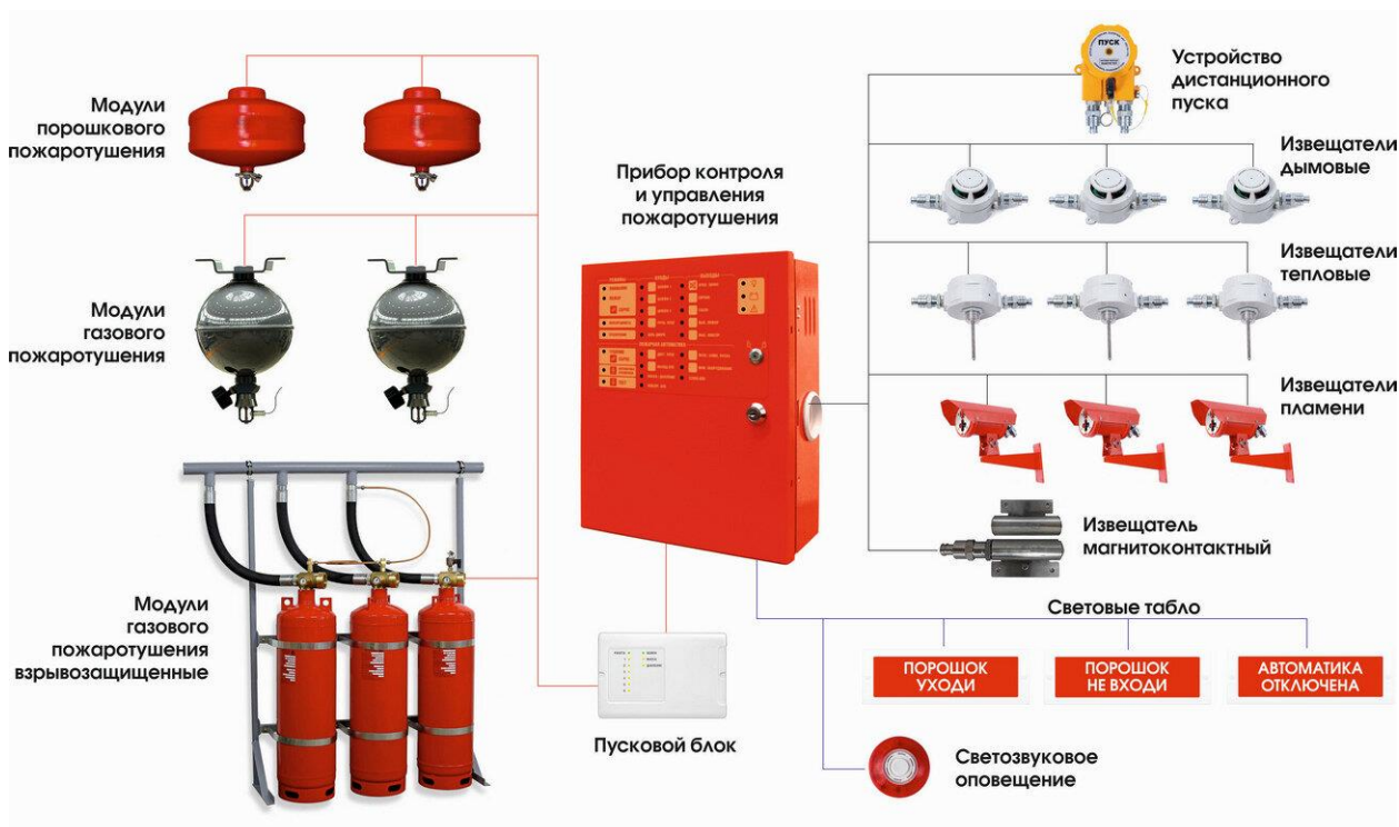
Рис. 3. Схема автоматической системы пожаротушения (АУПТ)
