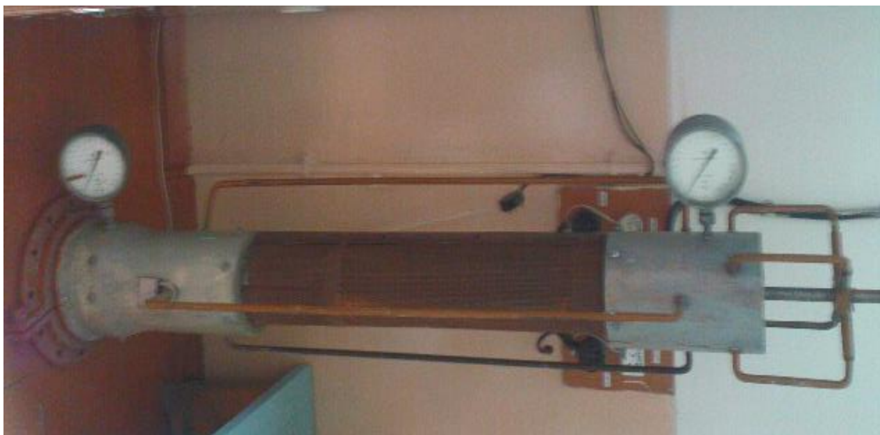
Рис. 3. Устройства для разделения навозных стоков со шнеком-турбиной постоянного диаметра для съема и транспортирования осадка
