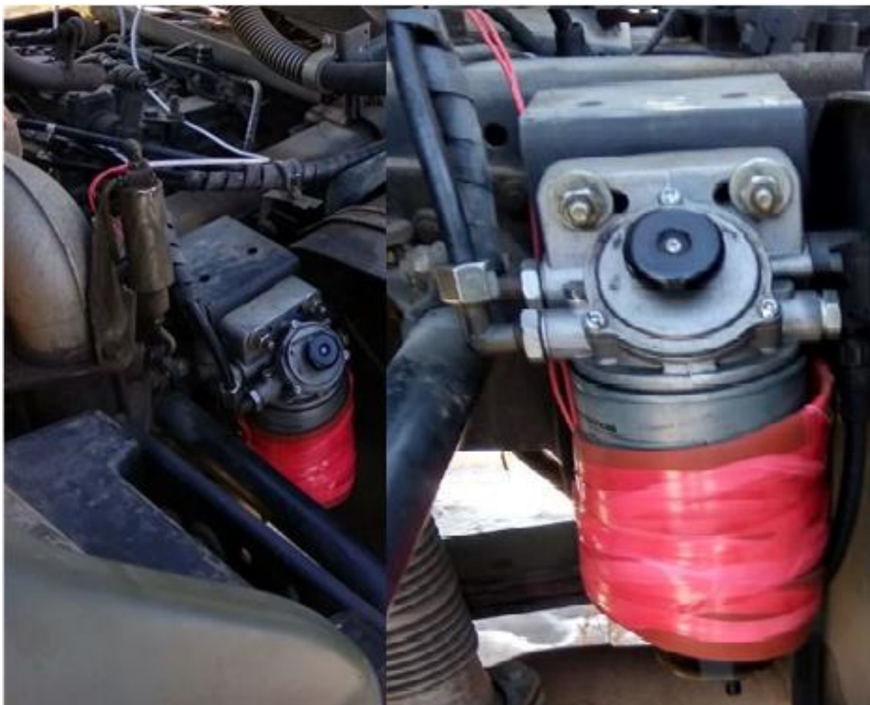
Рис. 3. Опытное электронагревающее устройство
