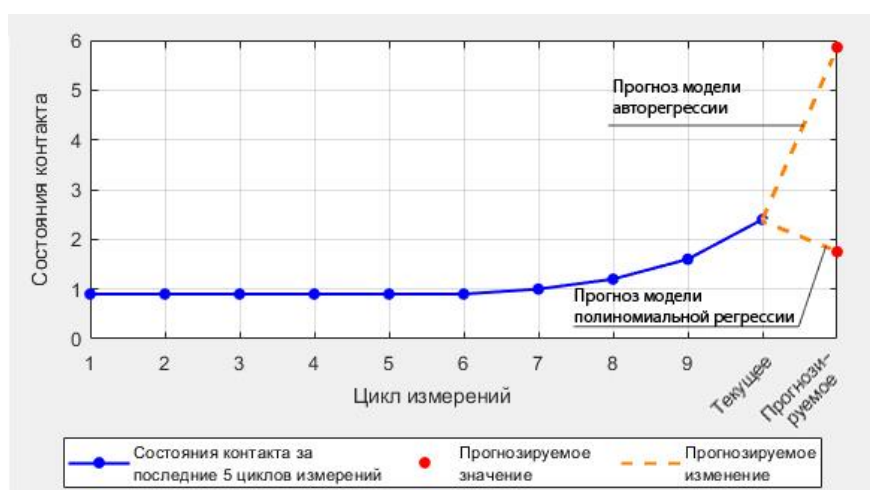
Рис. 3. Прогноз состояния контактного соединения на основе 10 известных значений при ухудшении состояния контакта
