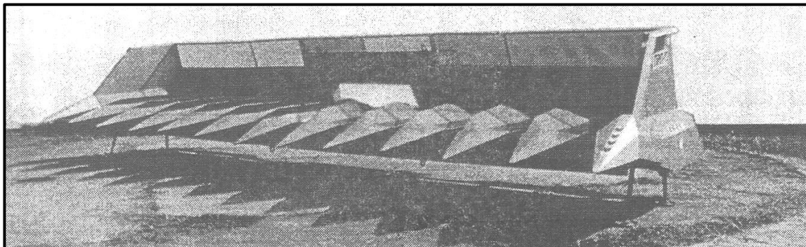
Рис. 3. Приспособление 12-рядное для уборки подсолнечника ПРП-12. Вид спереди слева
