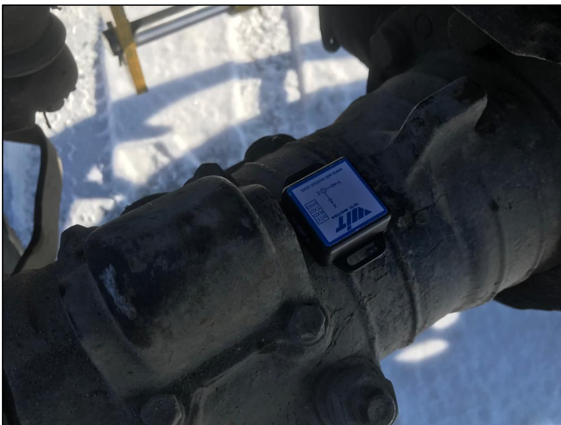
Рис. 2. Фрагмент проведения исследований по определению вертикального смещения переднего моста трактора в движении
