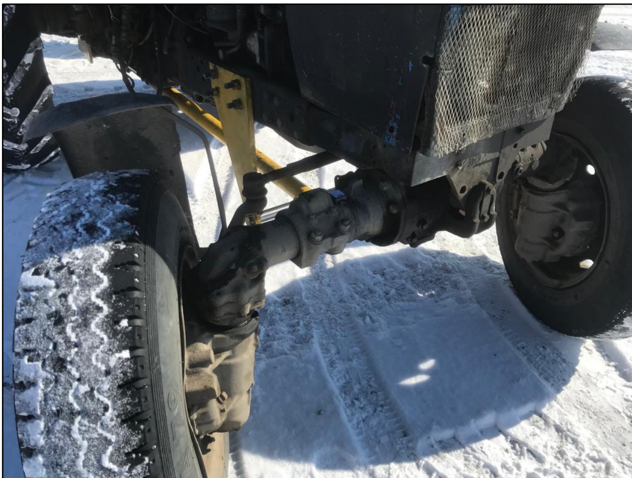
Рис. 3. Фрагмент проведения исследований по определению колебаний управляемого моста трактора с экспериментальным ТСУ в повороте
