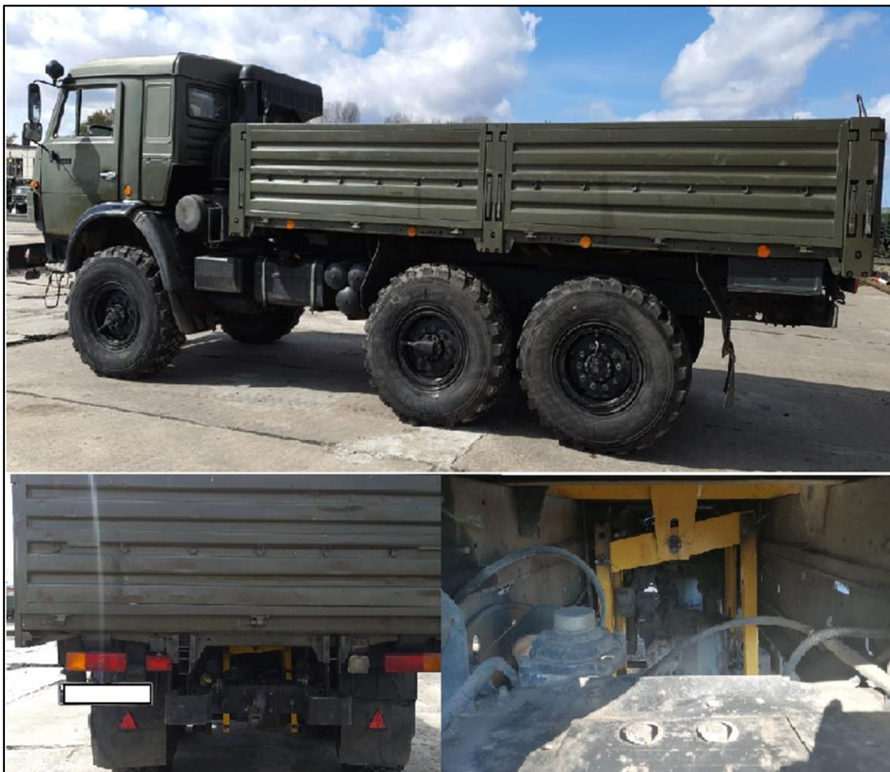
Рис. 1. Общий вид многоцелевого автомобиля, оборудованного устройством для перераспределения нагрузки между двигателями
