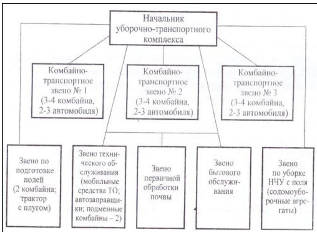
Рис. 1. Структурная схема и состав уборочно-транспортного комплекса (УТК) для уборки зерновых колосовых культур
