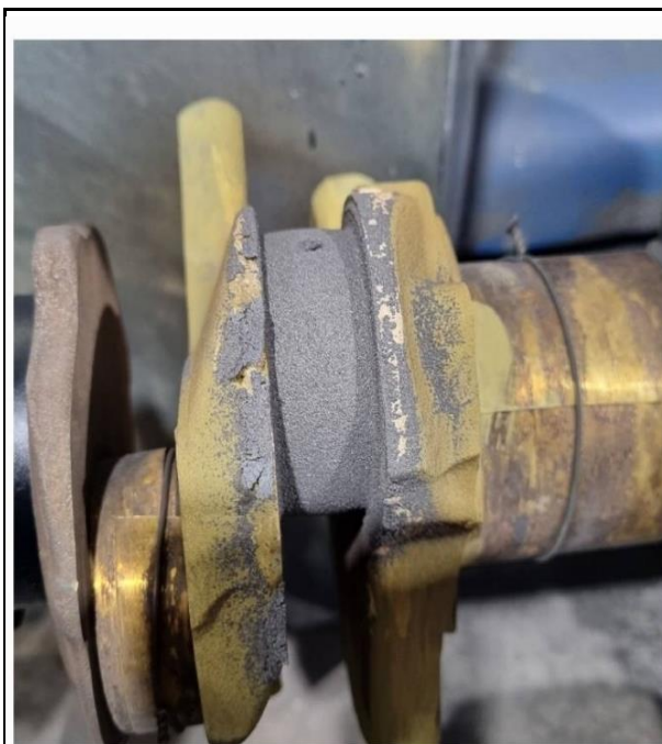
Рис. 4. Образец № 1 с напылением порошком RotoTec® HardTec 19300
