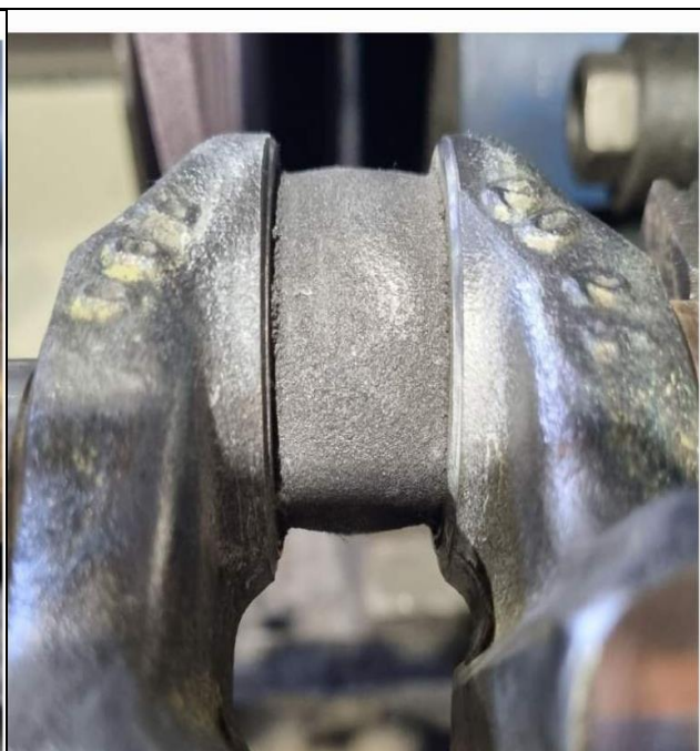
Рис. 5. Образец № 2 с напылением порошком RotoTec® HardTec 19400
