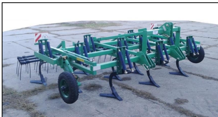
Рис. 4. Культиватор КМН-4-01 с пружинным шлейфом в рабочем положении
