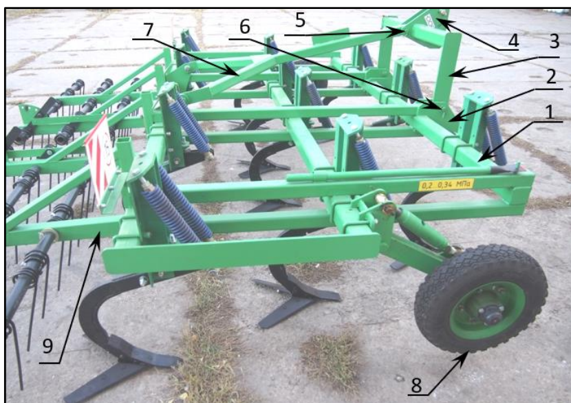
Рис. 6. Устройство культиватора КМН-4-01
