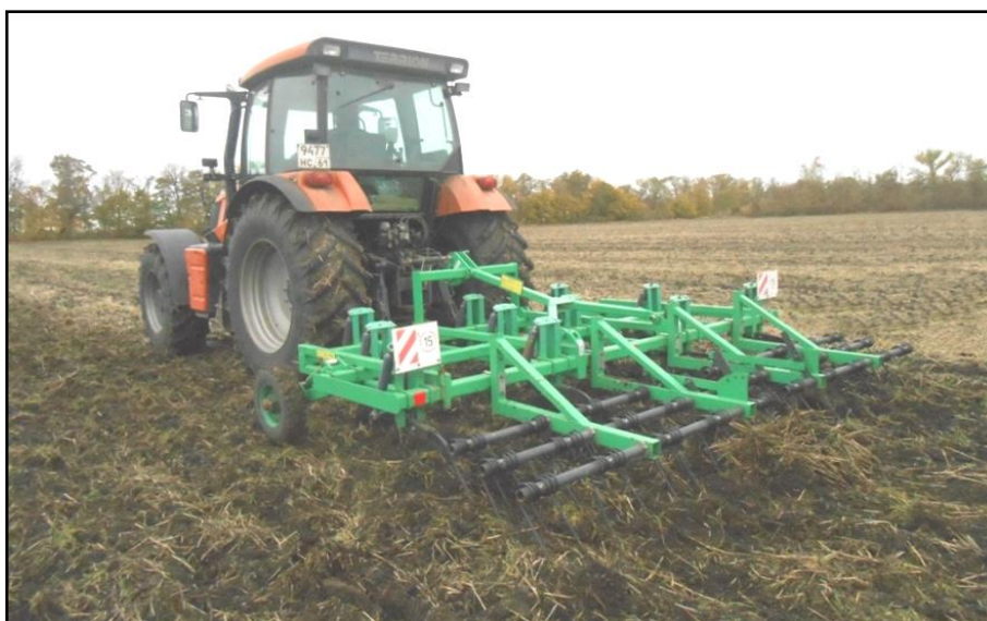
Рис. 8. Гребни и борозды после прохода агрегата с трактором АТМ-3180 при рабочей скорости 10 км/ч
