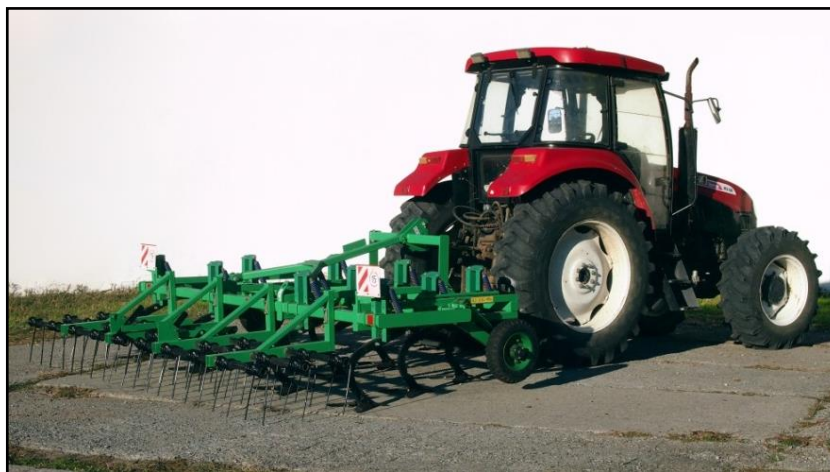
Рис. 7. Культиватор КМН-4-01 в агрегате с трактором ЛТЗ-130 в рабочем положении
