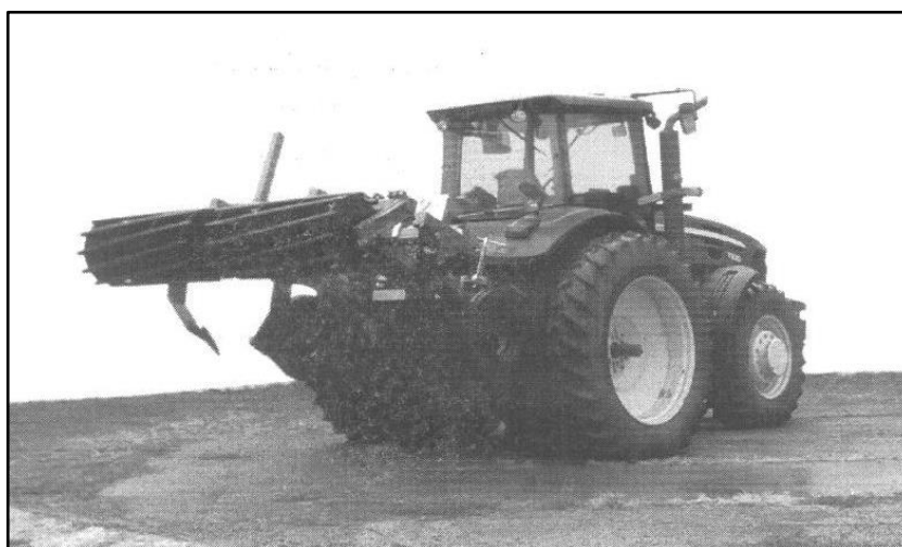
Рис. 7. Рыхлитель влагосберегающий навесной РВН-3 в агрегате с трактором John Deere 7830 в транспортном положении
