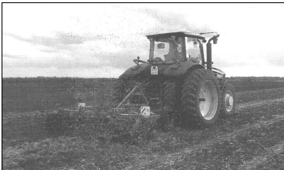
Рис. 8. Рыхлитель влагосберегающий навесной РВН-3 в агрегате с трактором John Deere 7830 в работе
