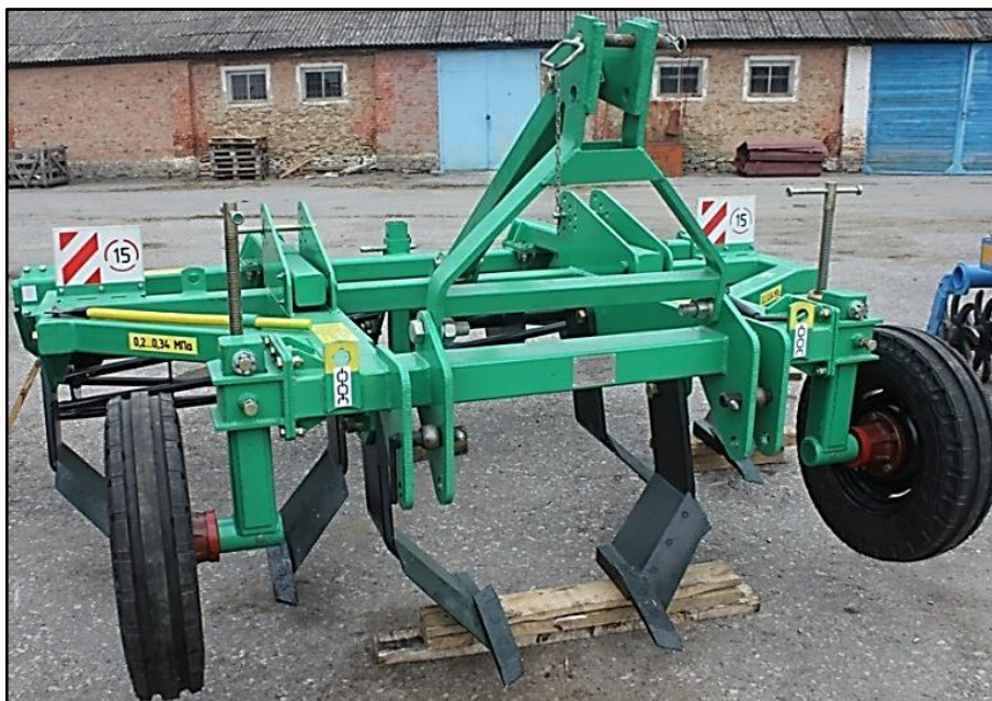
Рис. 2. Общий вид глубокорыхлителя влагосберегающего навесного РВН-3
