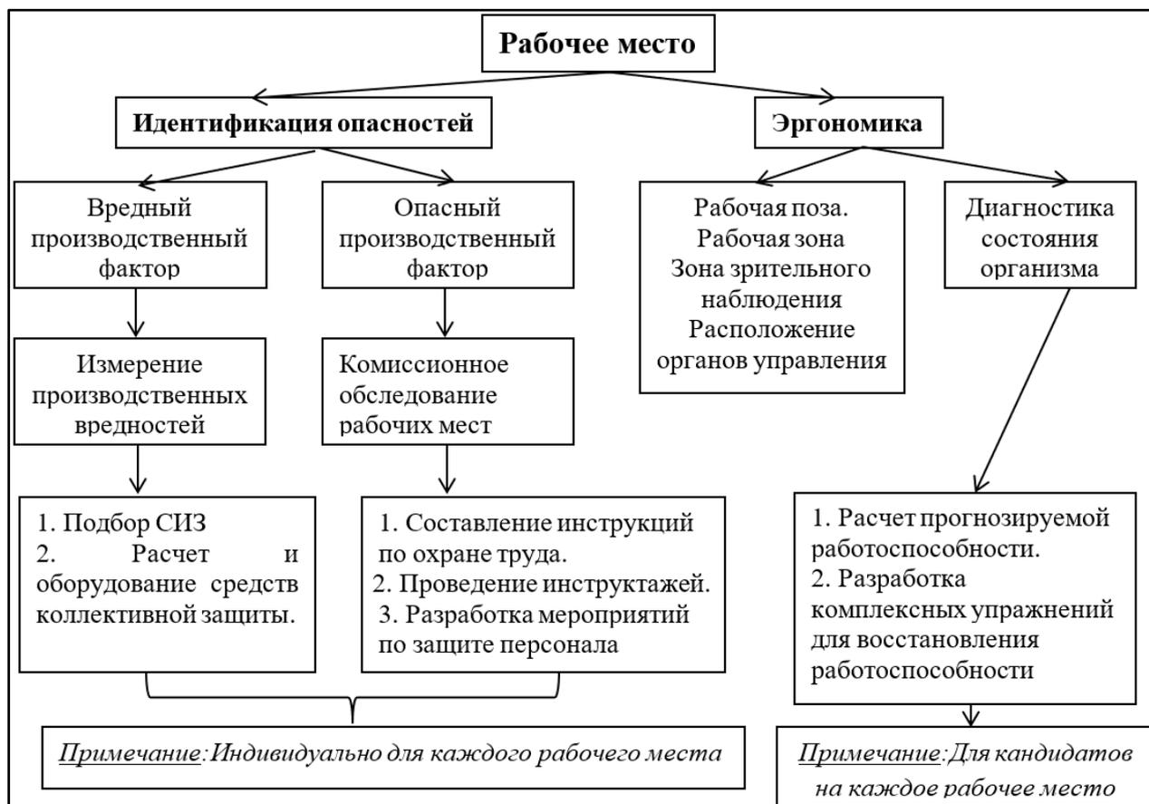
Рис. 4. Схема характеристики рабочего места
