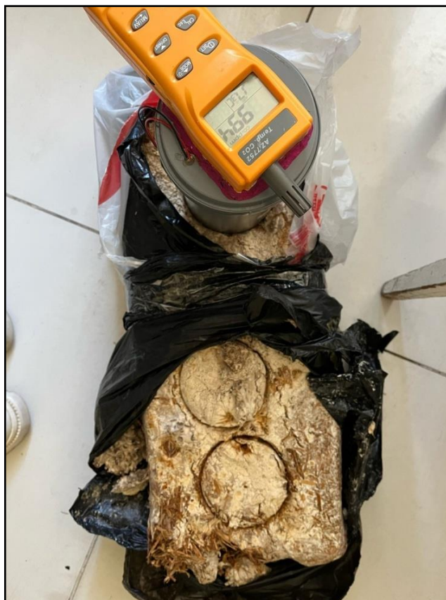
Рис. 1. Процесс прямого измерения потоков \text{CO}_2 из отработанного грибного блока Вешенки обыкновенной ( Pleurotus ostreatus )
